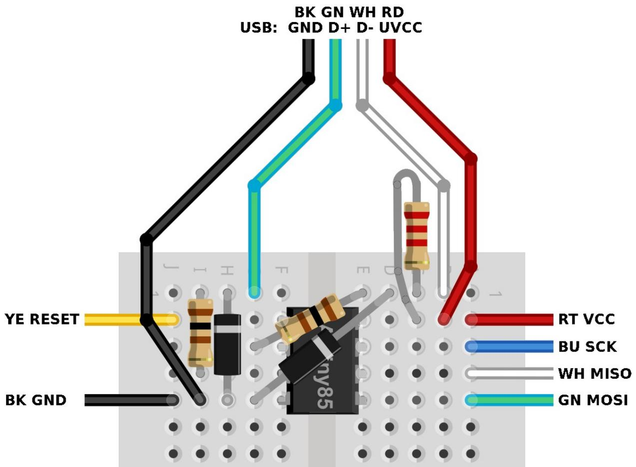
Im Bild sehen Sie die von oben ankommenden Anschlussleitungen des USB-Kabels. An den Seiten sind die Leitungen dargestellt, mit denen der Ziel-Mikrocontroller – das so genannte Target – programmiert wird. Diese Leitungen besitzen das gleiche Farbschema, das sie möglicherweise schon vom guloboard her kennen.
