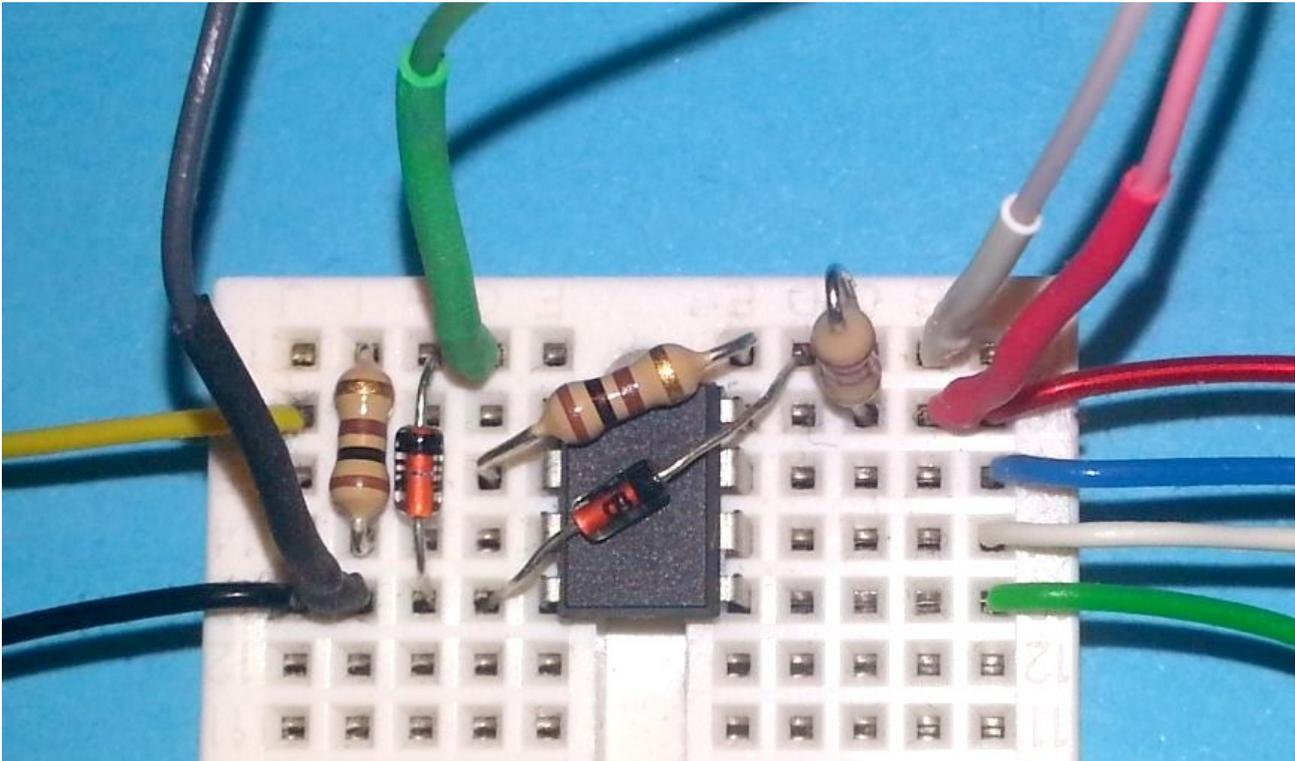
Vor dem Anschließen an den Computer stellen Sie sicher, dass alle Bauteile korrekt und an der richtigen Stelle aufgesteckt sind und dass alle nichtisolierten Drähte berührungsfrei sind. Der Target-Mikrocontroller muss korrekt angeschlossen sein und darf keine Verbindung zur Ziellanwendung besitzen, er darf also nicht gleichzeitig in einer anderen Schaltung sitzen. Am besten, Sie ziehen ihn aus der Ziellanwendung heraus und setzen ihn alleine auf einen freien Platz der Steckplatine.
