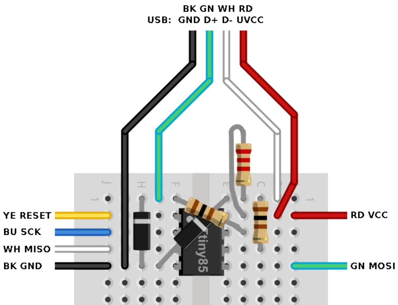
Im Bild sehen Sie die von oben ankommenden Anschlussleitungen des USB-Kabels. An den Seiten sind die Leitungen dargestellt, mit denen der Ziel-Mikrocontroller – das so genannte Target – programmiert wird. Diese Leitungen besitzen das gleiche Farbschema, das sie möglicherweise schon vom guloboard her kennen.
